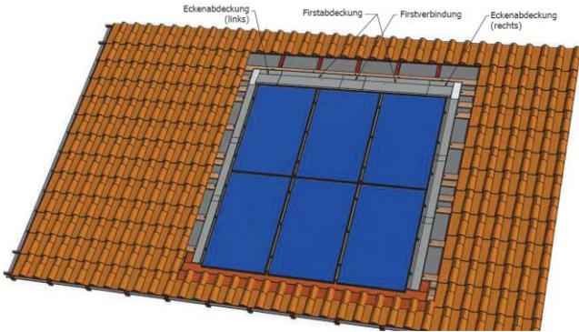
Die Montage der Eckenbefestigungen und des Firstabdeckbleches müssen so erfolgen, dass das PV-Panel mit seiner Aufbauhöhe exakt passt. Entsprechende Aussparungen für die Eckenbefestigungen sind in den GSE-Rahmen vorzusehen.
