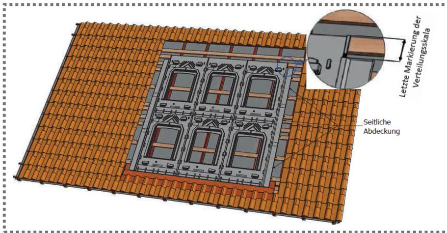
1 Anbringen der Keile in Höhe der Endklemmen unterhalb der Aussparung der Basisplatte
