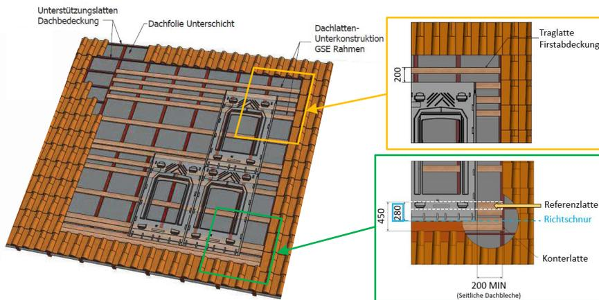
Der Querschnitt der Unterstützungslatten wird in Abhängigkeit der klimatologischen Bedingungen am Standort der PV-Anlage festgelegt. Zur Ermittlung der geltenden Schnee- und Windlastbeanspruchungen sind die entsprechenden Zonen zu berücksichtigen. Für Deutschland sind diese Vorgaben der Installationsanleitung auf Seite 12 en 13 zu entnehmen.
