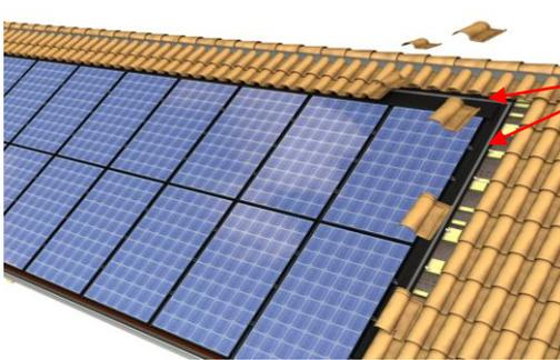
Anbringen von Quellband an den Seiten und oben der Abdeckbleche um die PV-Modulfläche
