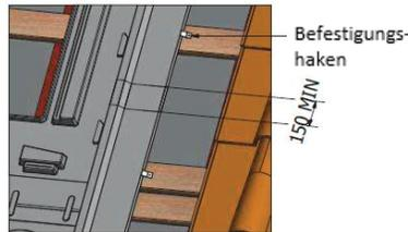
3 In Höhe der Endklemmen und zusammen mit den Keilen sind die GSE-Basisplatten zu verbohren
