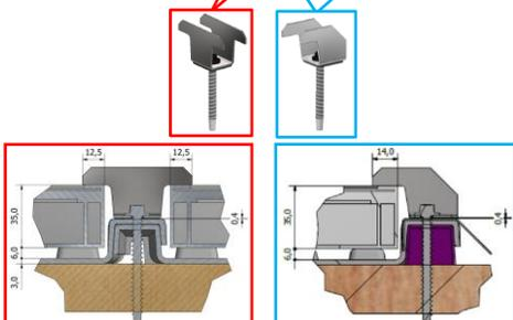
Das PV-Panel wird mittels den oberen – Stützrippen auf seine Position fixiert und ruht dabei auf den Noppen der Basisplatte.
