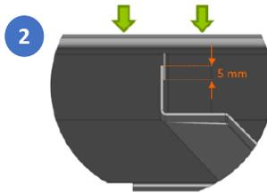
2. Anpassen der Höhe der Abdeckblechecke durch übereinander Legen der beiden Teile
