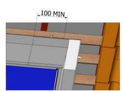
Falls erforderlich, ist abhängig von der eingesetzten GSE-Basisplatte und der PV-Panelhöhe, das Eckenabdeckblech gemäß nebenstehender Tabelle in 3 Arbeitsschritten auszuspren
