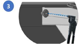
3. Nach Einstellen der richtigen Höhe, sind in den übereinander liegenden Teile um Popnieten zu setzen 4,5mm Bohrungen einzubringen
