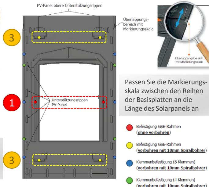
Passen Sie die Markierungsskala zwischen den Reihen der Basisplatten an die Länge des Solarpanels an
